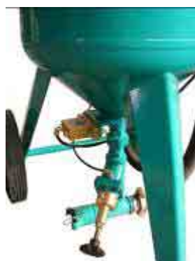
GRUPO MEZCLA ABRASIVO CON VIBRADOR PARA FACILITAR LA SALIDA DEL ABRASIVO
